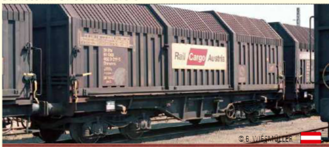
Teleskophaubenwagen Shimms ÖBB, Rail Cargo Austria Betriebs-Nr. 31 80 4671 273-9
